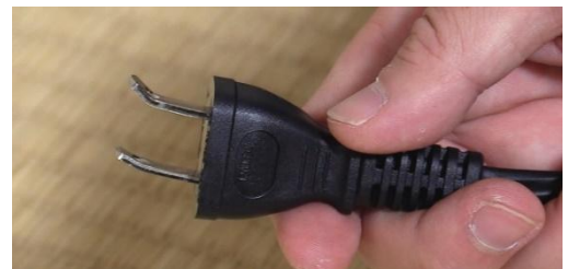
変形した電源プラグ
