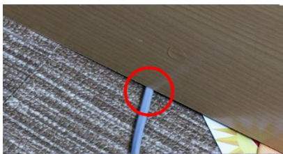
電源コードが下敷きになっている様子
