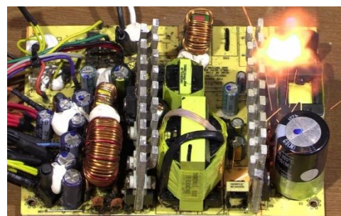
浸水した製品の発火（パソコンの基板）
