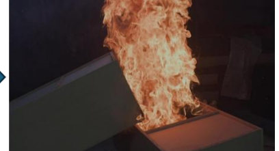
電源コードからの発火による火災
