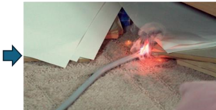
断線した電源コードから発火
