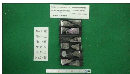
図参 7－試験後試料の破壊状況
