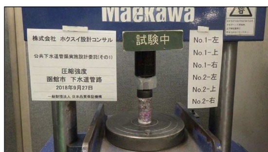
図参 6－圧縮強度試験状況
