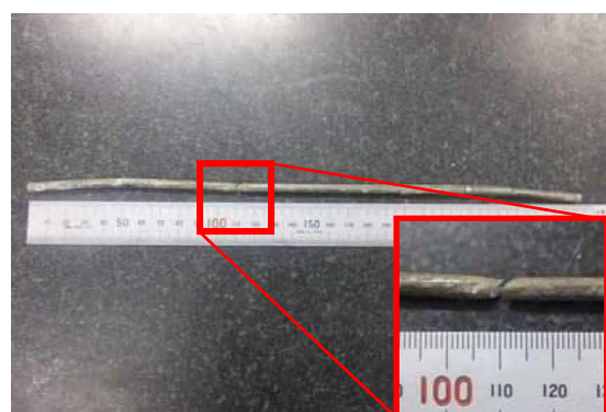
図参 12－試験後試料の破断状況
