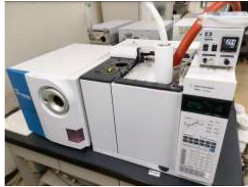
ガスクロマトグラフ質量分析計 (消毒副生成物の検査に使用)
