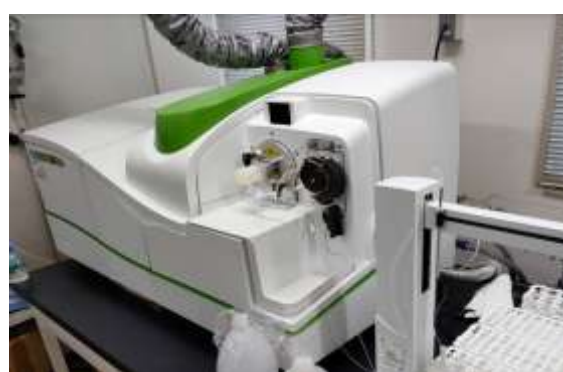
誘導結合プラズマ質量分析装置 （金属類の検査に使用）
