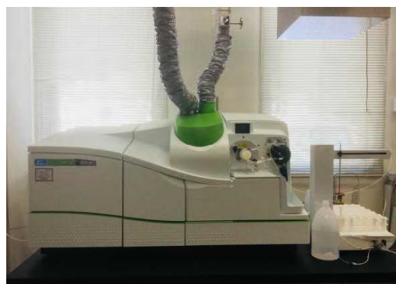
誘導結合プラズマ質量分析計（ICP-MS） (金属類の検査に使用します)
