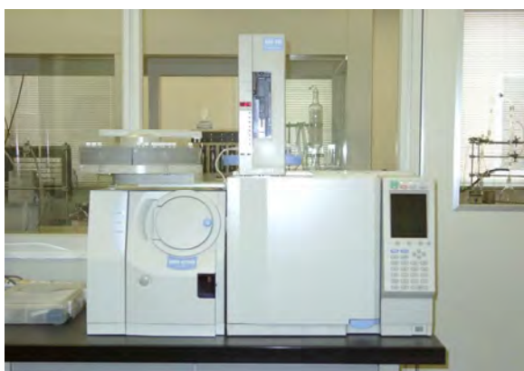
ガスクロマトグラフィー質量分析計 (消毒副生成物や農薬類の検査に使用します)
