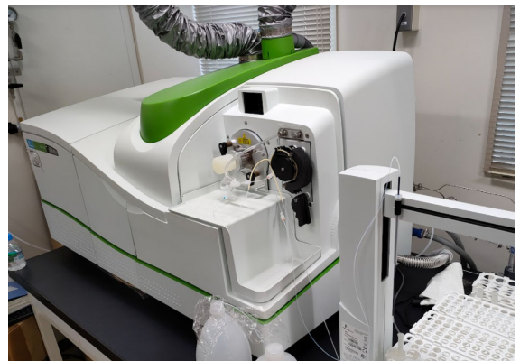
誘導結合プラズマ質量分析装置 (金属類の検査に使用)
