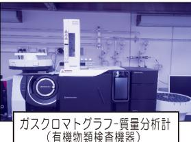
ガスクロマトグラフ-質量分析計（有機物類検査機器）
