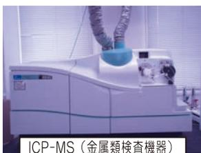
ICP-MS（金属類検査機器）
