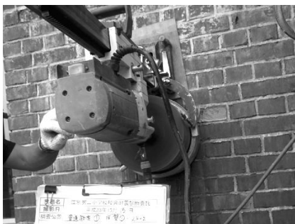
コアボーリングによる供試体採取状況
