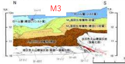
Ts-1トレンチ東側法面: 変状が認められる (比高約35cm〔岩盤の段差及び段丘堆積物中の層理面の段差〕) (補足説明資料P.4-28, P.4-58~P.4-67参照)
