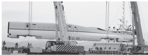
▲新幹線車両の陸揚げ
