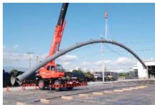
耐震継手の水道管
