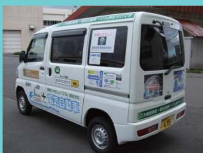
環境部では、今年の9月から、走行中に二酸化炭素を排出しない電気自動車を日常業務において有効活用することで、市の事務事業における、二酸化炭素を削減するとともに、地球温暖化対策のシンボルとして電気自動車を導入しました。この電気自動車は、ごみ焼却発電を利用して充電するため、二酸化炭素の排出量がゼロとなっています。また、走る広告塔として、地球温暖化防止に関心のある企業等の広告を掲載し、日常の業務で市内各所を走行しています。
