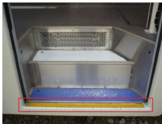
【滑り止めシールの設置】
