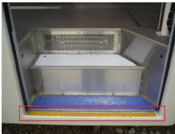
【滑り止めシールの設置】
