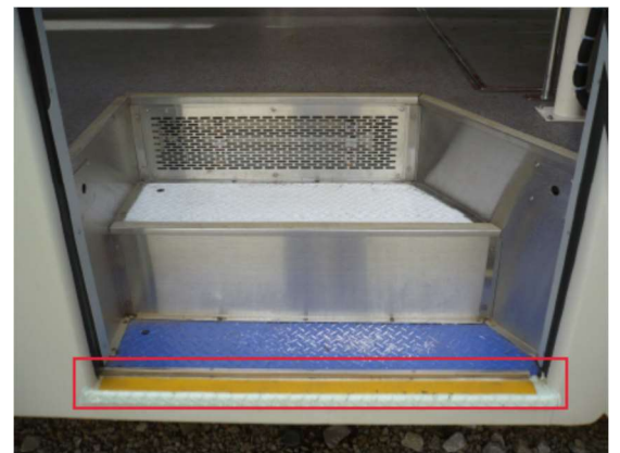
【滑り止めシールの設置】
