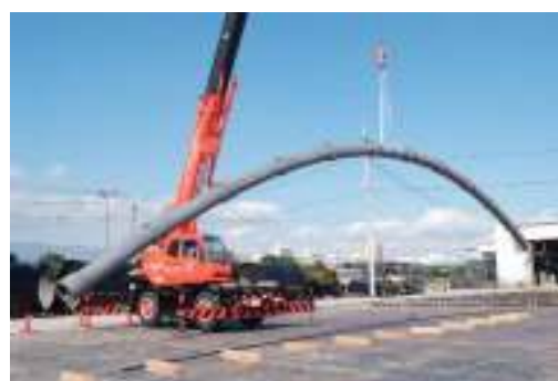
耐震継手の水道管
